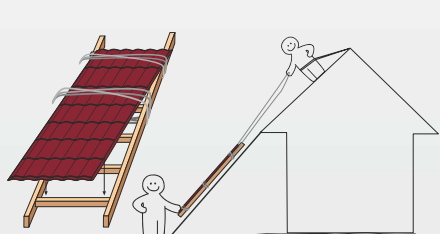
Подъём листов на кровлю
