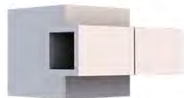
Спереди столба встык (сварка)
